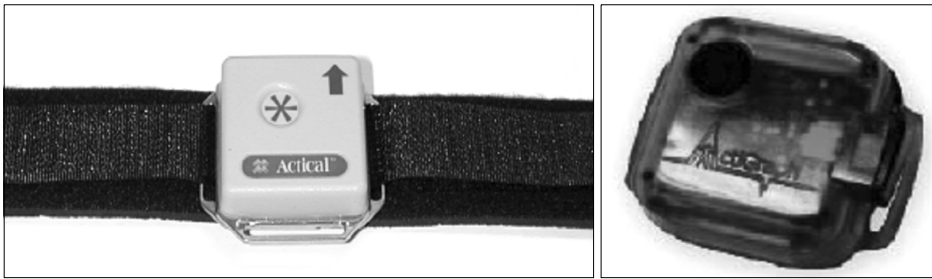
그림 1. 두 3차원 동작감지기의 착용전 모습(좌: 액티칼, 우: 액티그라프).
