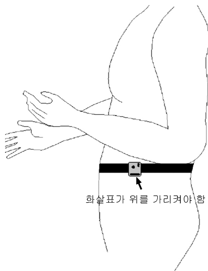
그림 2. 액티칼의 바른 착용방법. 액티칼은 탄력밴드로 고정하여 골반의 장골능에 위치하도록 하고, 착용 시 반드시 액티칼에 표시된 화살표가 위쪽을 향하도록 한다.
